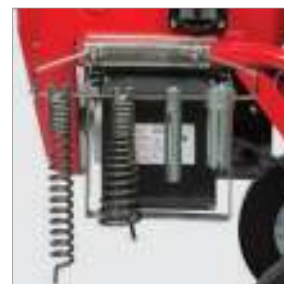
Удобный держатель для прочистных насадок
