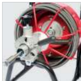
V-Clean с механизмом автоподачи
